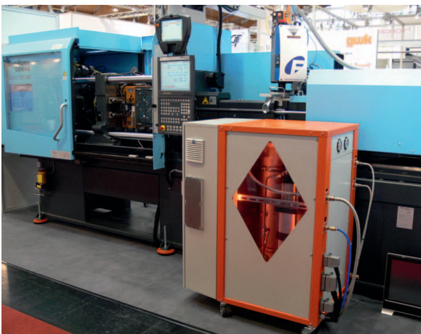
Bild 7. Die Anlage für dynamische Formnesttemperierung vereint Aufheizen und Abkühlen im schnellen Wechsel mit Temperaturgradienten von bis zu 20 K/s (Foto: gwK)
